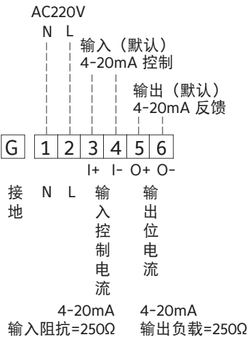
图5：模拟型执行器(型号带CDC)接线图(CDC)
